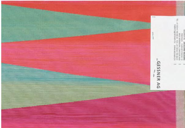
**Abb. 10:** Gewebekahn der Firma Gessner AG in Wädenswil, Jacquardgewebe mit Doppelschuss in unterschiedlichen Garnfarben, 100% Polyester, 2007.
