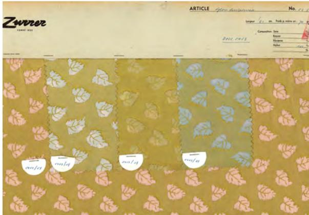
**Abb. 2:** Liasse aus dem Firmenarchiv Weisbrod-Zürrer AG in Hausen am Albis, Leinwandbindung mit Druck, Nylon (Polyamid), 1940–1960.
