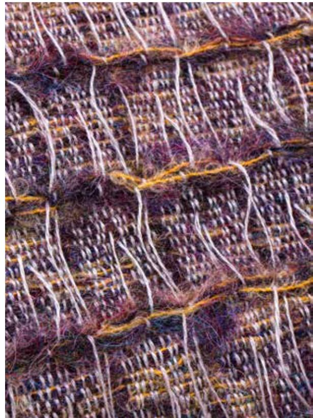
Abb. 8: Gewebe aus der Bindungspatrone, dargestellt in Abb. 7.
