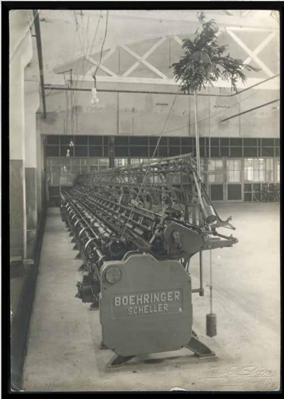
Abb. 1: Die erste Cottonmaschine westdeutscher Produktion im Elbeo-Werk, später Bi-Lauingen.
